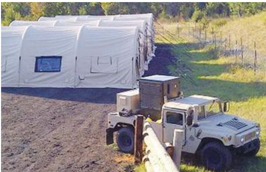
GEN-G được lắp đặt trên xe để cung cấp nước
